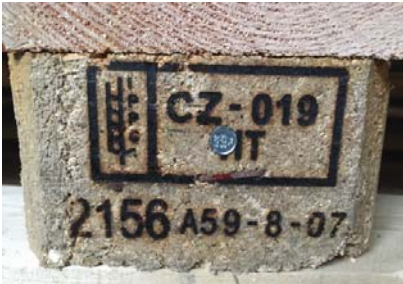
Gwoździe naprawcze są znormalizowane i oprócz oznaczenia kraju siedziby firmy naprawczej i logo SGS posiadają numer licencji naprawczej
